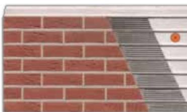
Klinkerlap burkolat előregyártott fugavezetős polisztirolhab táblából készült hőszigetelő rendszeren
